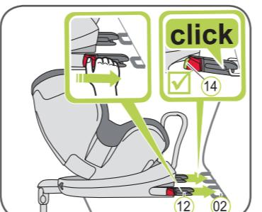
3. Uchopte dětskou sedačku oběma rukama a zasuňte obě zajišťovací ramena (12) pevně do vodicích vložek (02), aby zajišťovací ramena s kliknutím zapadla na obou stranách. Zelené indikátory ISOFIX (14) musí být viditelné na obou stranách.
