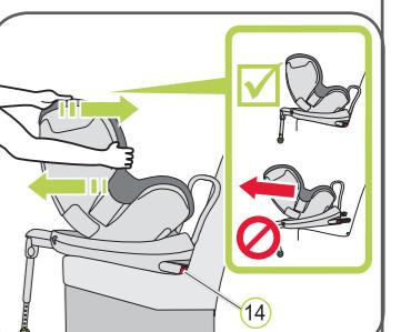
8. Zatřete dětskou bezpečnostní sedačkou, abyste se ujistili, že je bezpečně upevněna, a znova zkonzrolujte, že oba indikátory ISOFIX (14) jsou úplně zelené.
